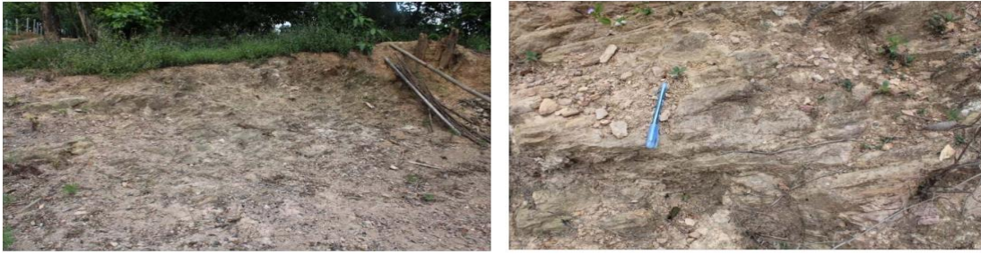
รูปที่ 3.2.1-2 ลักษณะของดินดินดานสลับชั้นกับดินโคลน หมู่ 2 บ้านแม่คาววัง พิกัด 573981 E / 2171281 N
